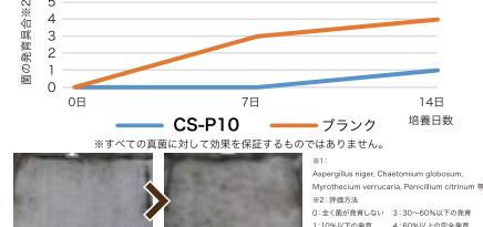
試験方法: MIL-STD-810D Method 508・3法法律試験菌種: 真菌71種 試験期間: 14日間
